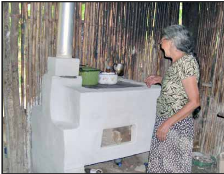
Con adobe, base de cemento y horno.
