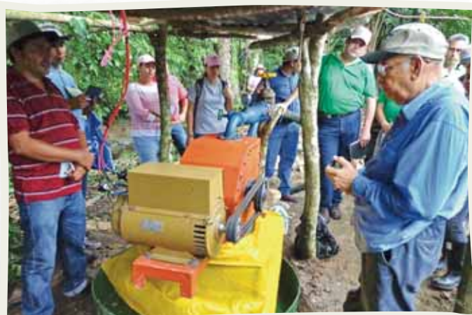
El Ing. Roberto Fromm, hace una demostración sobre el funcionamiento de una micro turbina Pelton.
